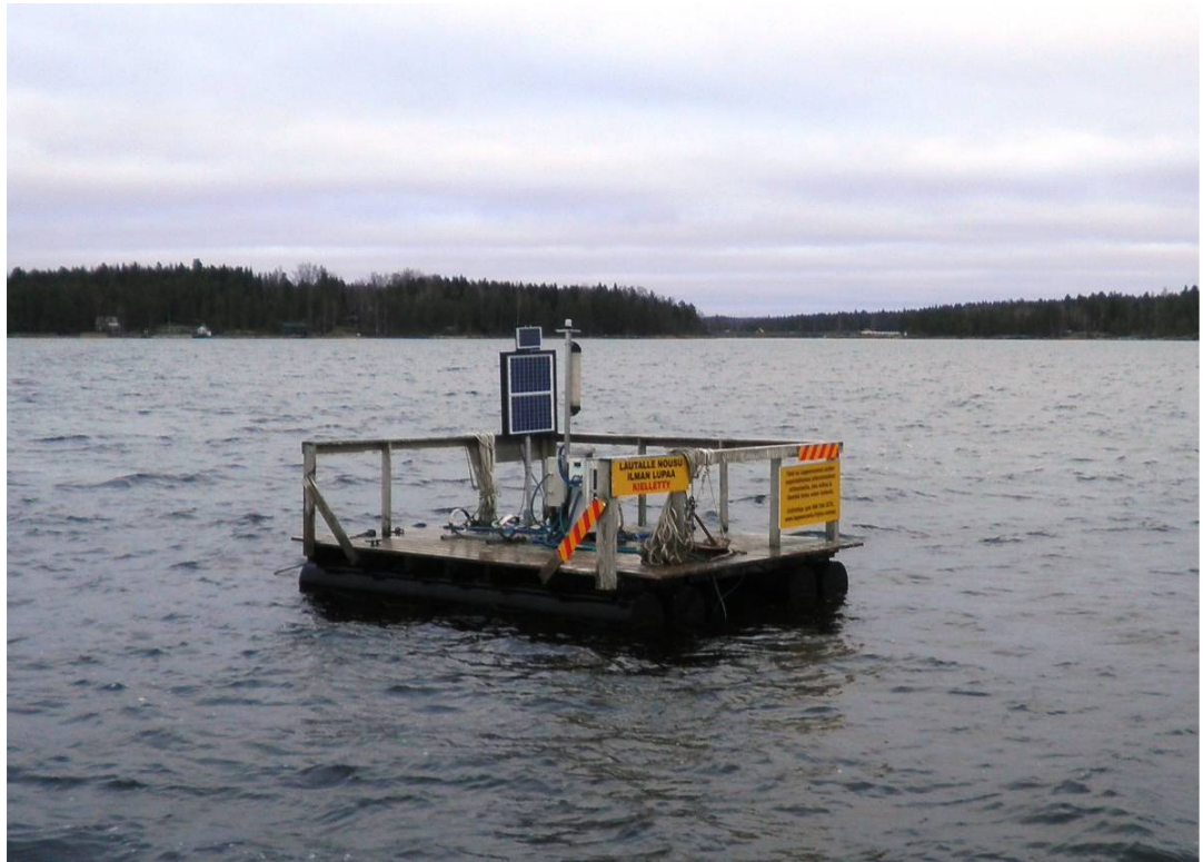
Automaattinen mittauslautta Lappeenrannan Piiluvanselällä
